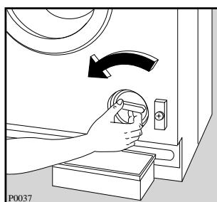
Промойте ее аккуратно проточной водой. Установите сетку на место.
